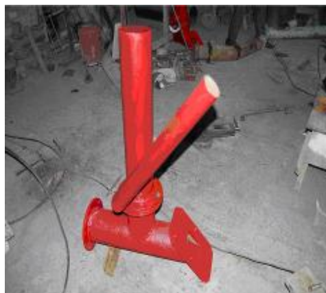
Гидротараннинг схемаси ва унинг АТКМ да яратилган ишчи нусхаси
