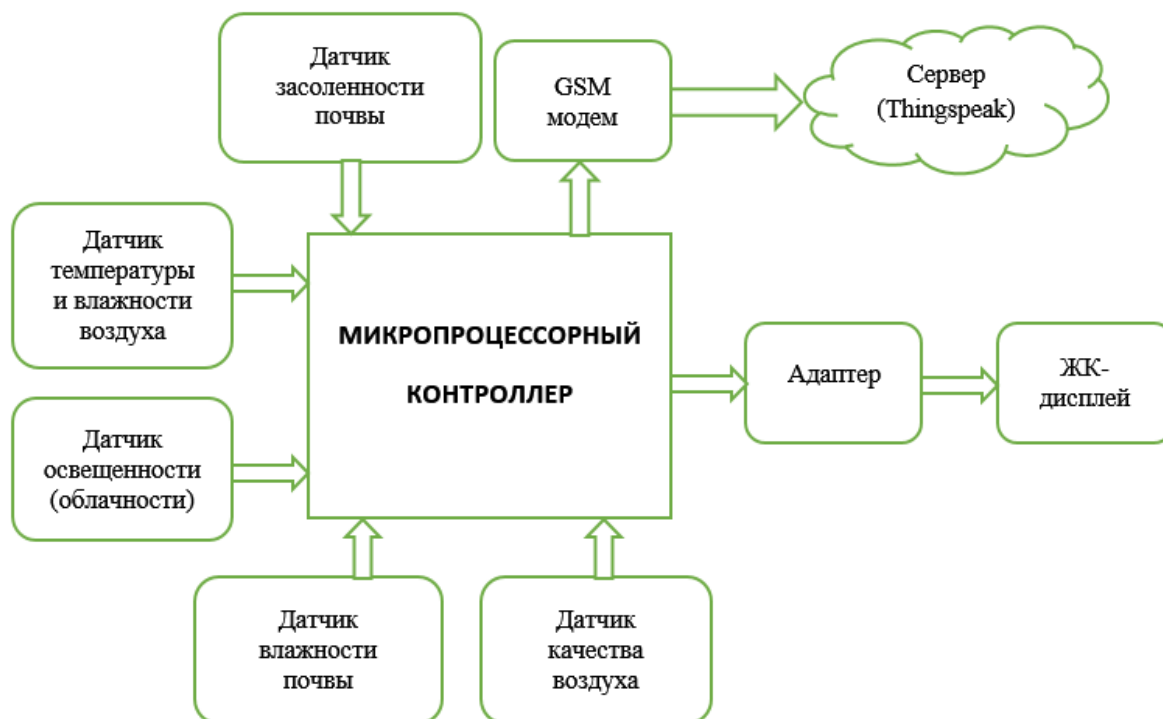
Рисунок 1. Блок-схема интеллектуальной системы мониторинга процесса полива на основе IoT
