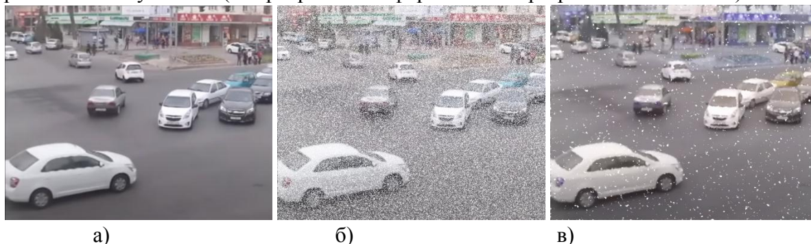
Рис. 1. Экспериментальные исследования по подавлению шума «соль и перец» на тестовом изображении «Перекрёсток».
